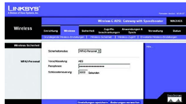
Abbildung 6-17: Wireless Security Sicherheit im Wireless-Netzwerkbetrieb – WPA2-Personal
